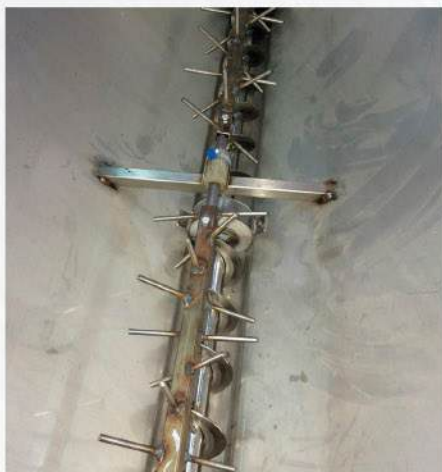
Particolare interno cassetta con coclea
