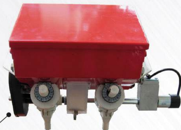
Cassetto per concime microgranulare, motorino elettrico e caricabatterie adattabili su motocoltivatori
