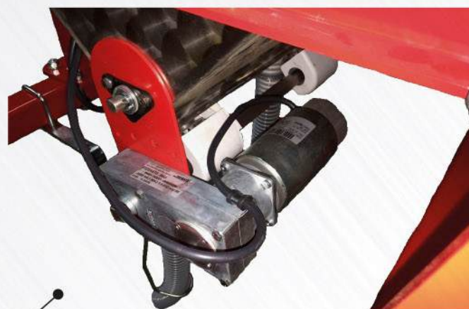
Particolare motorino elettrico
