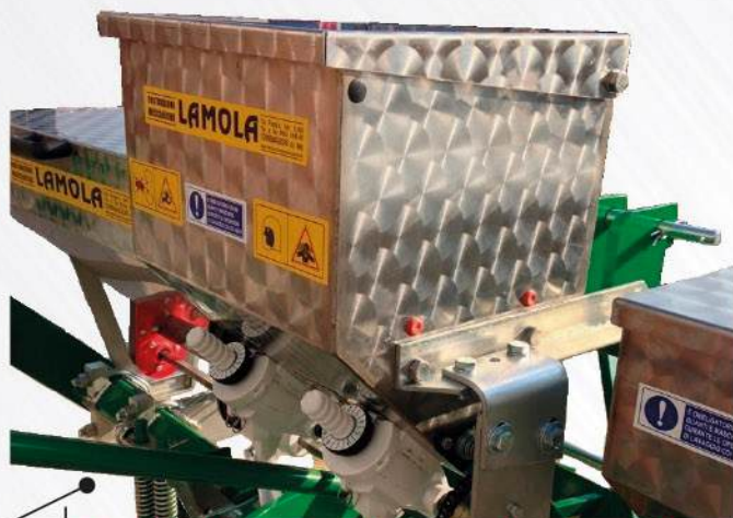
Particolare cassette per microgranulare e veleno su sarchiatrice
