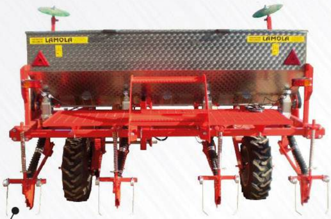
Cassetto per fave con trasmissione meccanica
