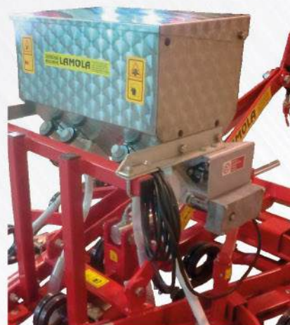
Cassetto su estirpatore per vigneto con trasmissione elettrica
