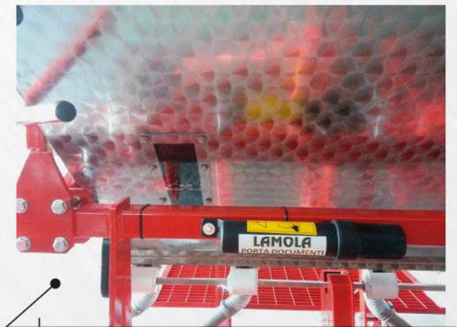
Particolare finestra per livello concime
