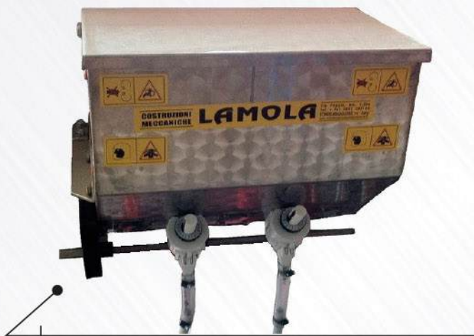
Cassetto per concime microgranulare
