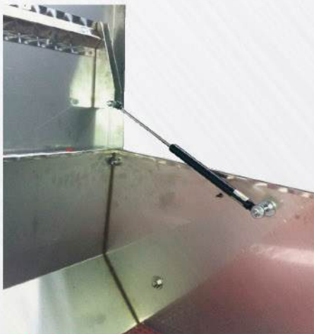
Particolare apertura e fermo coperchio
