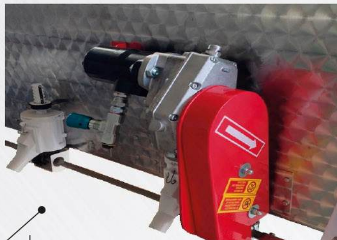
Particolare motore idraulico
