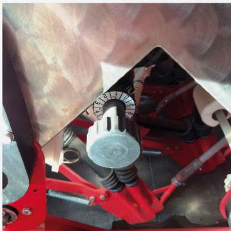
Particolare manopola regolazione apertura distributori
