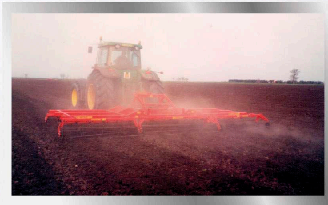
Vibrocoltivatore 7 mt con barra livellatrice anteriore e doppio rullo posteriore Vibrocultor 7 mt with leveling bar and double rear roll
