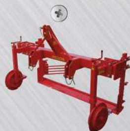
Vibrocoltivatore 7 mt con barra livellatrice anteriore e doppio rullo posteriore Vibrocultor 7 mt with leveling bar and double rear roll
